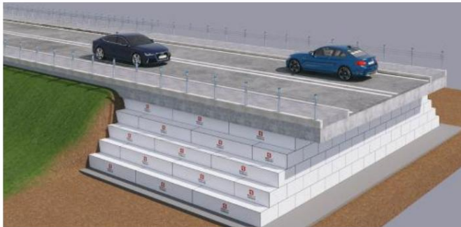
Figure 1 Il est utilisé pour alléger la charge de conception à la place du remblai de terre utilisé dans les autoroutes, les ponts et les rampes d'accès.
